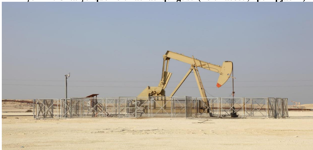
Şəkil 2. Orta Şərqdə neft hasilatı qurğusu (neft nasosu, “pumpjack”)
